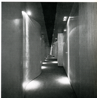
Fig. 12.3.f Il corridoio lungo il lato lungo dell'edificio è caratterizzato da pannelli in legno dalla forma sinusoidale, che hanno anche la funzione di mascherare alcuni impianti.
